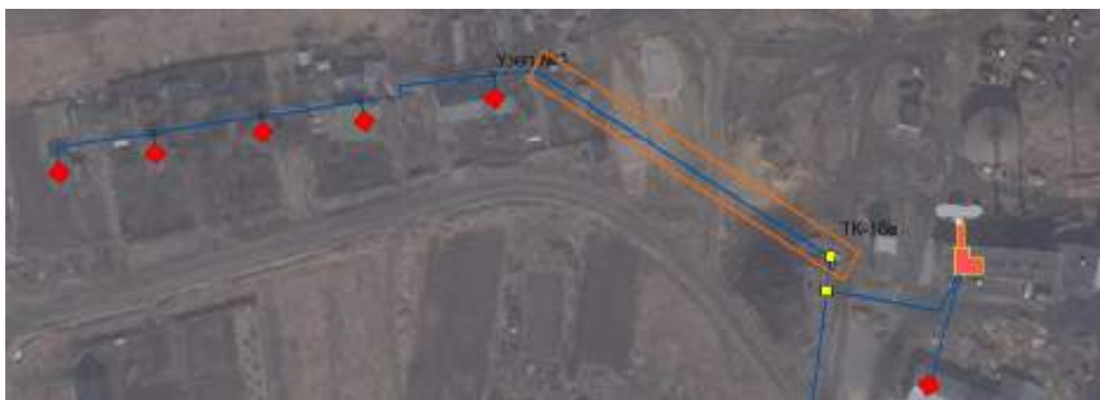
Рисунок 2.1.8.1 Участок трубопровода тепловой сети, проходящий через земельный участок, находящийся в частной собственности
