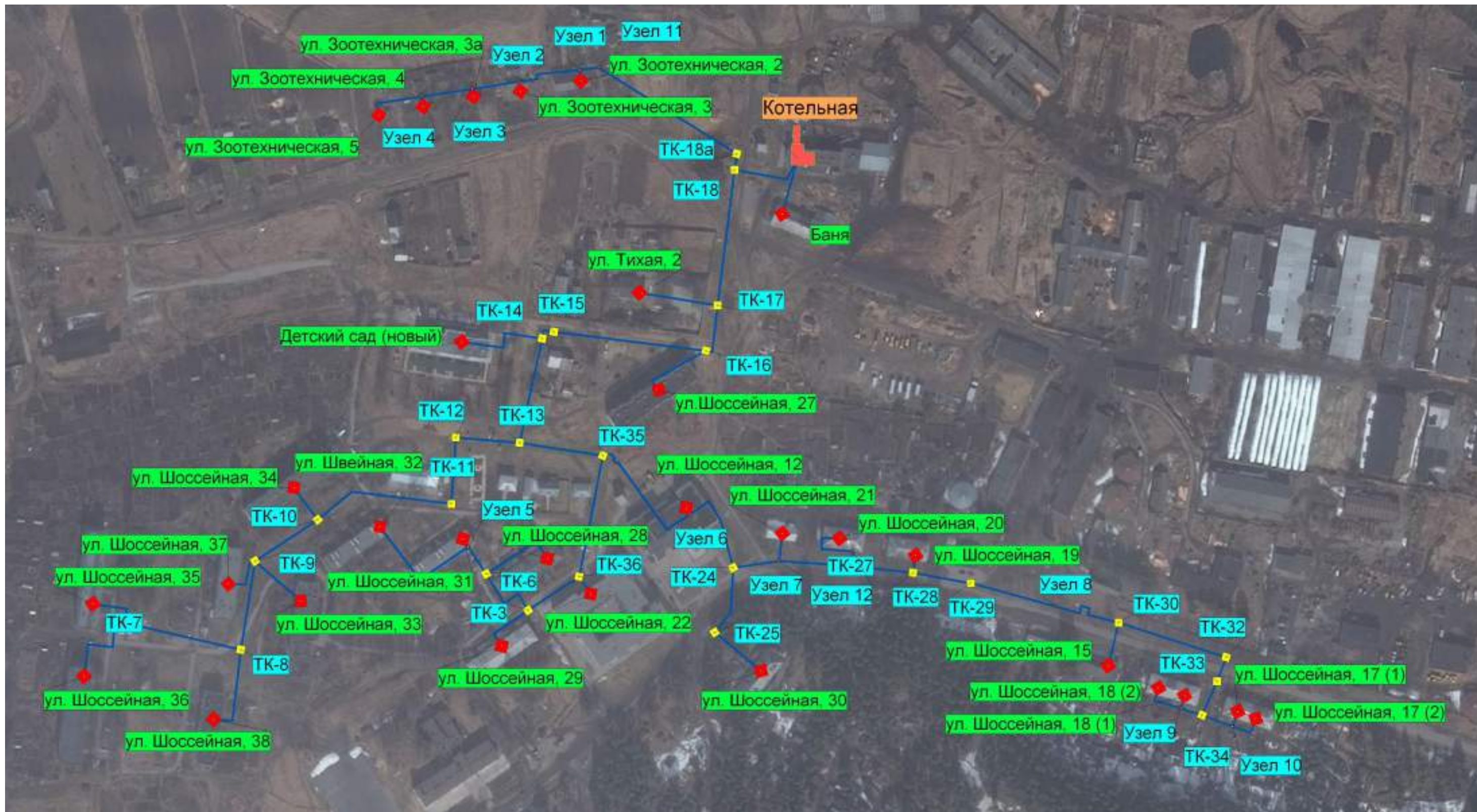
Рисунок 2.1.3.2 Существующая схема тепловой сети от котельной (отопление)
